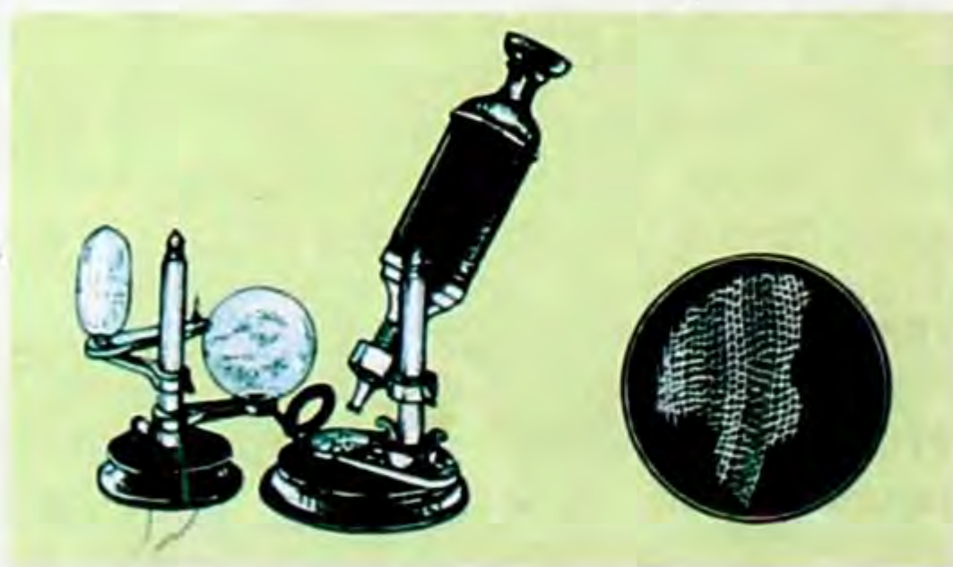
3-сүрөт. Р. Гуктун микроскобу жана Гук тарткан сүрөт – пробканын жука кесиндисиндеги көзөнөктөр – “клеткалар”.
